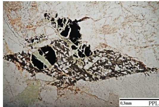
Foto 4 Drcený sfén titanitu. Petrografický mikroskop Olympus BX51. Foto M Gregerová.
